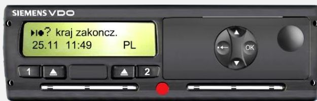
KRAJ ZAKOŃCZENIA – tuż po zakończeniu pracy
